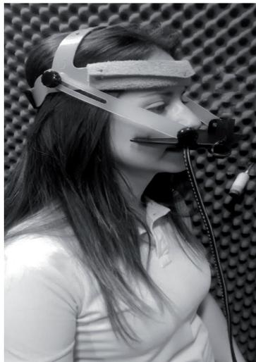
Figura 1 - Placa separadora de som (microfones oral e nasal) posicionada
