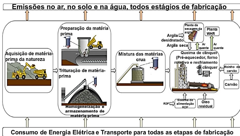
Figura 2: Processo de produção do cimento Portland
