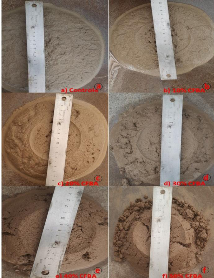
Figura 7: Ensaio de índice de consistência
